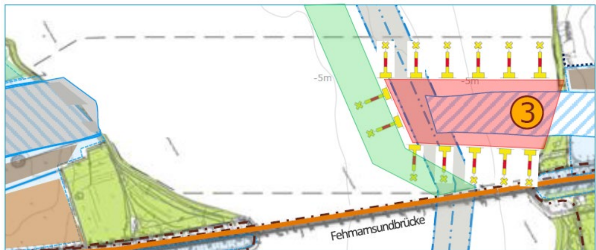
Abbildung 6-10: Schematische Lagen des verlegten Fahrwassers und des Sperrgebietes für die Phase 6
