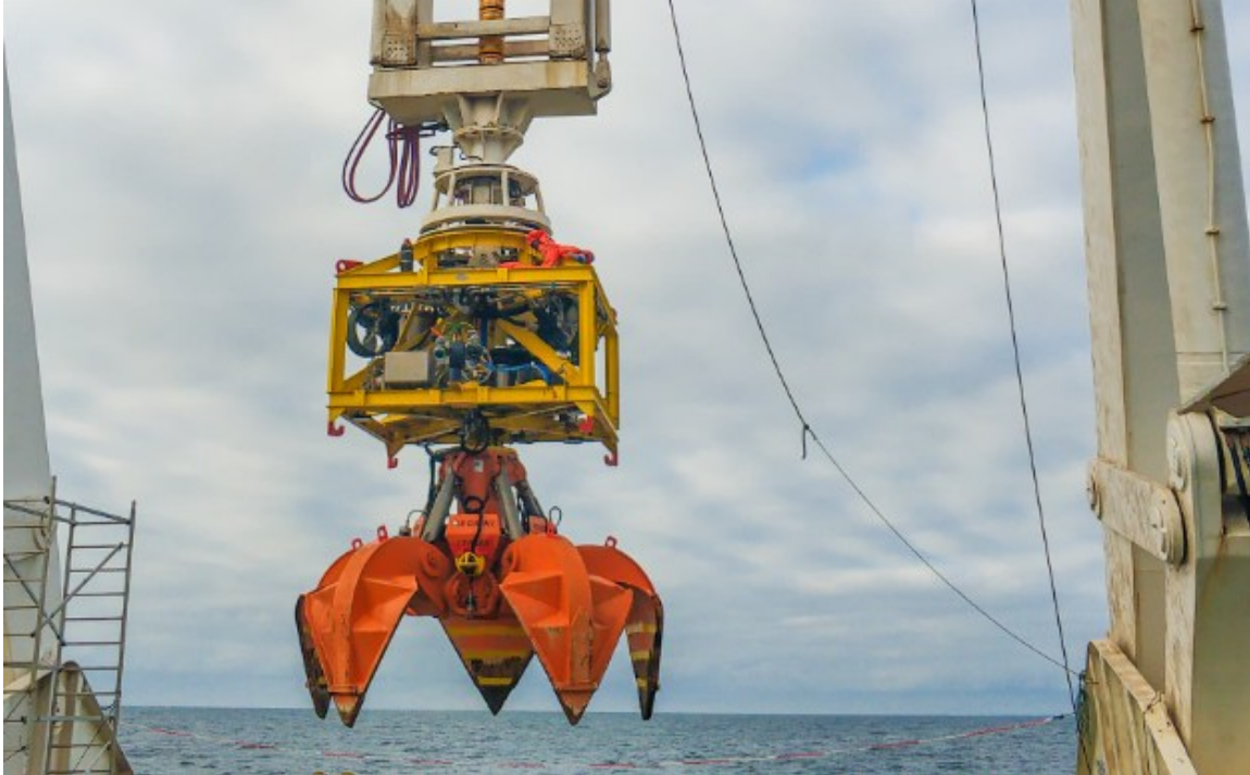
Abbildung 3.10 Assograpple II – ein multifunktionales Werkzeug für Eingriffe am Meeresboden (Quelle:
