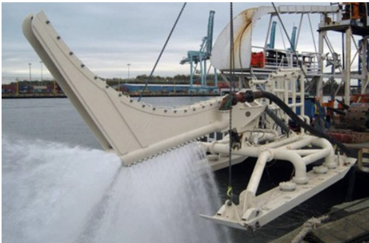
Abbildung 3.12 Mod-Jet/Sea Venture Stromkabelverlegungsschlitten (Quelle: https://eta-ltd.com/jetting-sleds-for-subsea-power-cable-laying/ )
