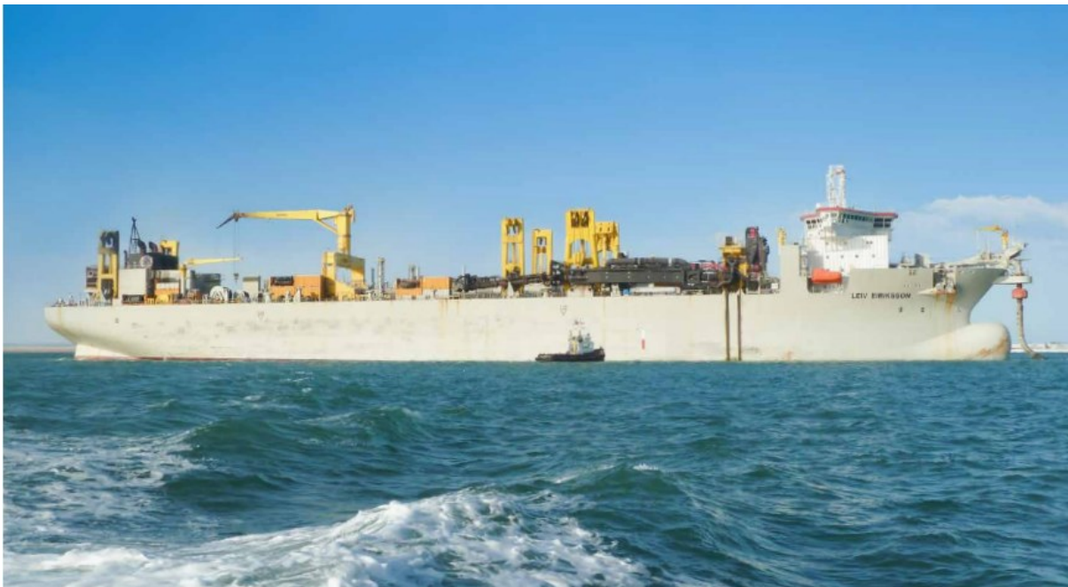
Abbildung 3.7 Beispiel für einen Schleppbagger mit Saugtrichter (Quelle:
