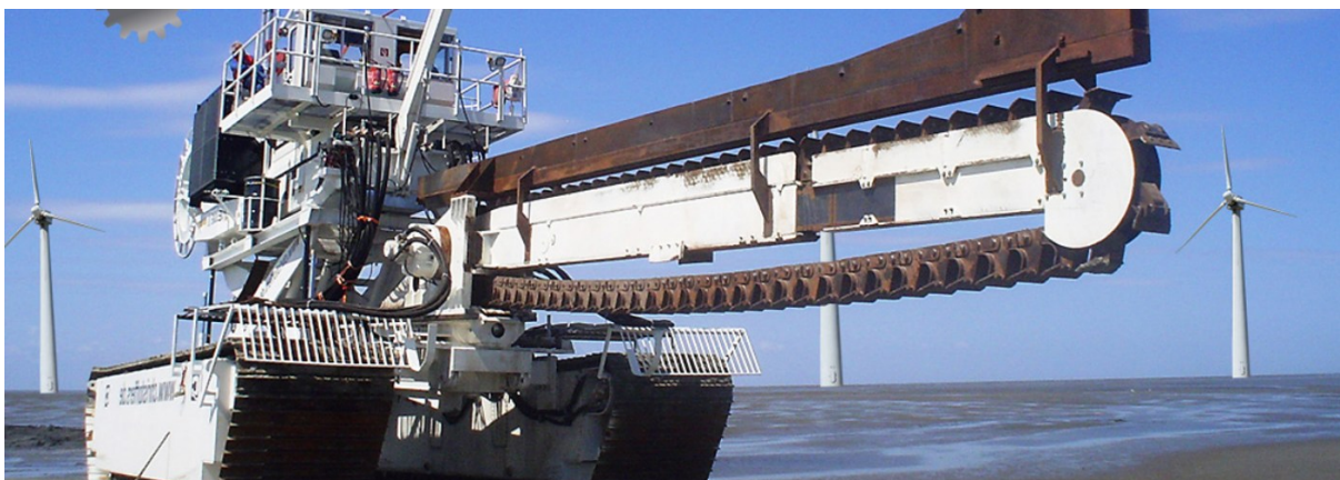
Abbildung 3.14 Ein Gerät zum Vergraben von Kabeln im Meeresboden. Quelle:
