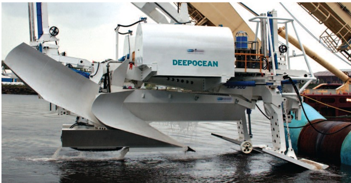
Abbildung 3.15 Fortschrittlicher AMP500-Mehrdurchgangspflug. Quelle: https://www.subsea-rov.com/services-assets/trenchers-ploughs/item/74-amp500
