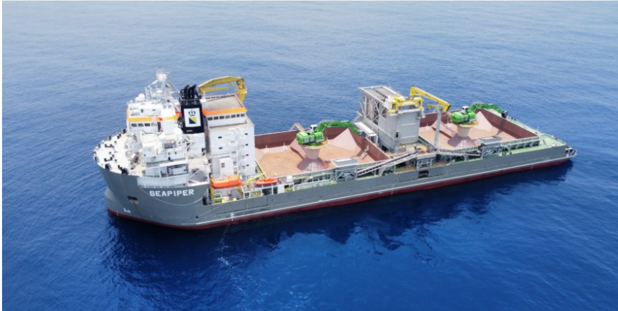
Abbildung 3.8 Beispiel für ein Fallrohrschiff (Quelle: https://www.portalmorski.pl/zegluga/53382-nowy-podsytkowiec-boskalisa )
