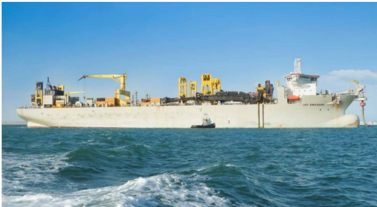
Rysunek 3.7 Przykładowa pogłębiarka wleczona ze zbiornikiem ssącym (źródło:
