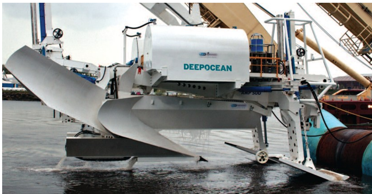
Rysunek 3.15 Zaawansowany pług wieloprzebiegowy AMP500. Źródło: https://www.subsea-rov.com/services-assets/trenchers-ploughs/item/74-amp500
