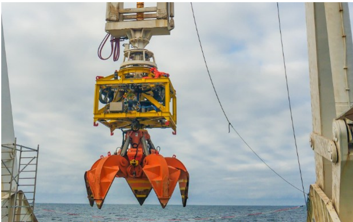
Rysunek 3.10 Assograpple II - wielofunkcyjne narzędzie przeznaczone do ingerencji w dno morskie (źródło:
