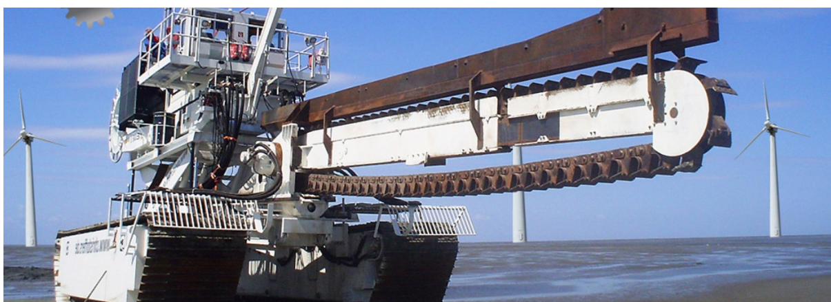
Rysunek 3.14 Urządzenie do zakopywania kabli w dnie morskim. Źródło: https://www.barthhollandrain.nl/page/161
