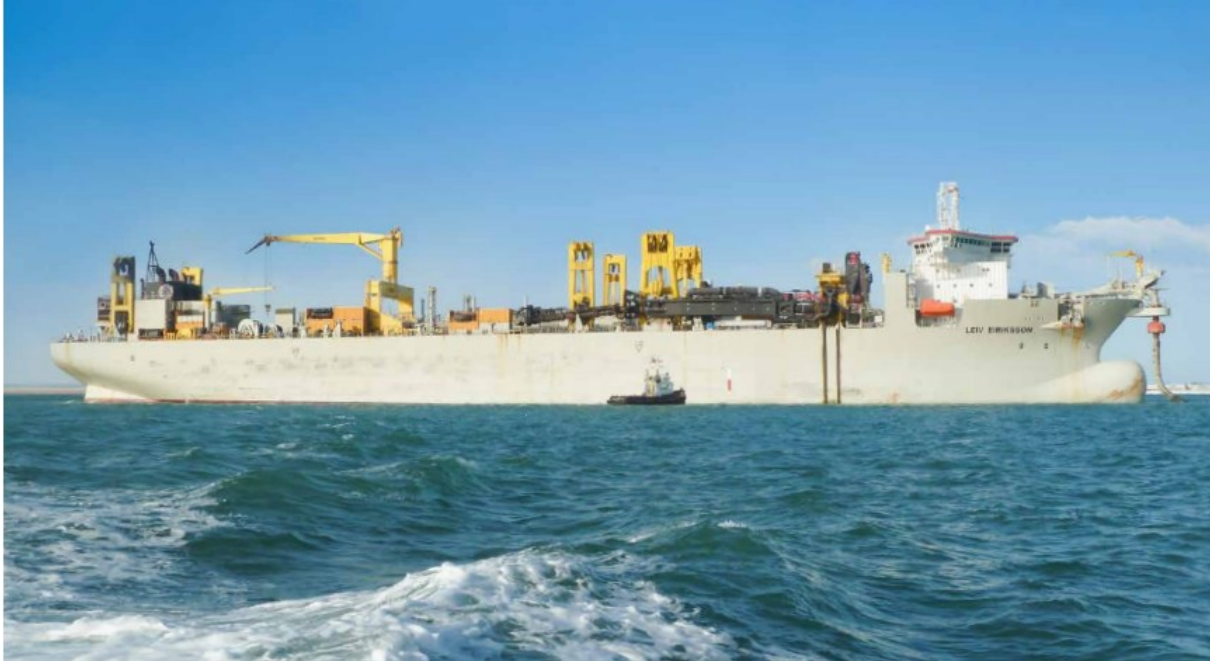
Figur 3.7. Exempel på mudderverk med sugbehållare (källa: https://www.jandenul.com/sites/default/files/2020-05/Leiv%20Eiriksson%20%28EN%29.pdf )
