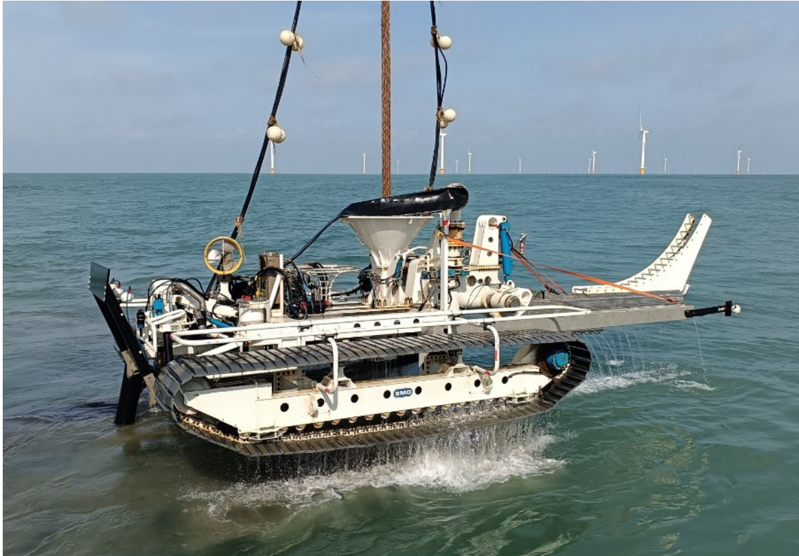
Figur 3.13. Grävmaskin för grunt vatten (Shallow Water Trencher) (källa: https://www.smd.co.uk/blog/may-2023-smds-shallow-water-trencher-the-story-so-far/ )
