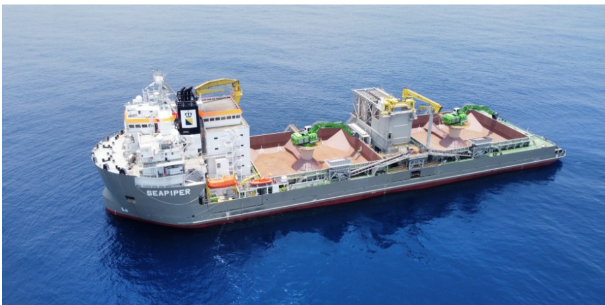
Figur 3.8. Exempel på fallrörsfartyg (källa: https://www.portalmorski.pl/zegluga/53382-nowy-podsytkowiec-boskalisa )
