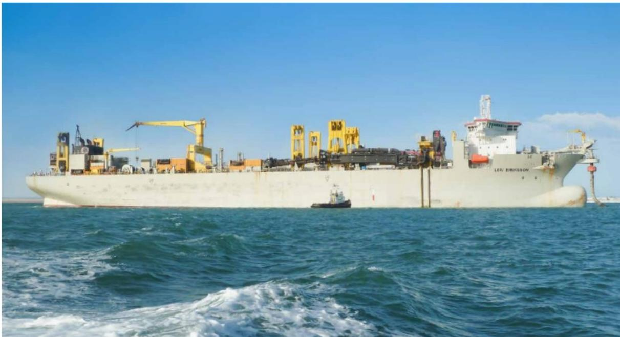
Abbildung 3.7 Beispiel für einen Schleppbagger mit Saugtrichter (Quelle:
