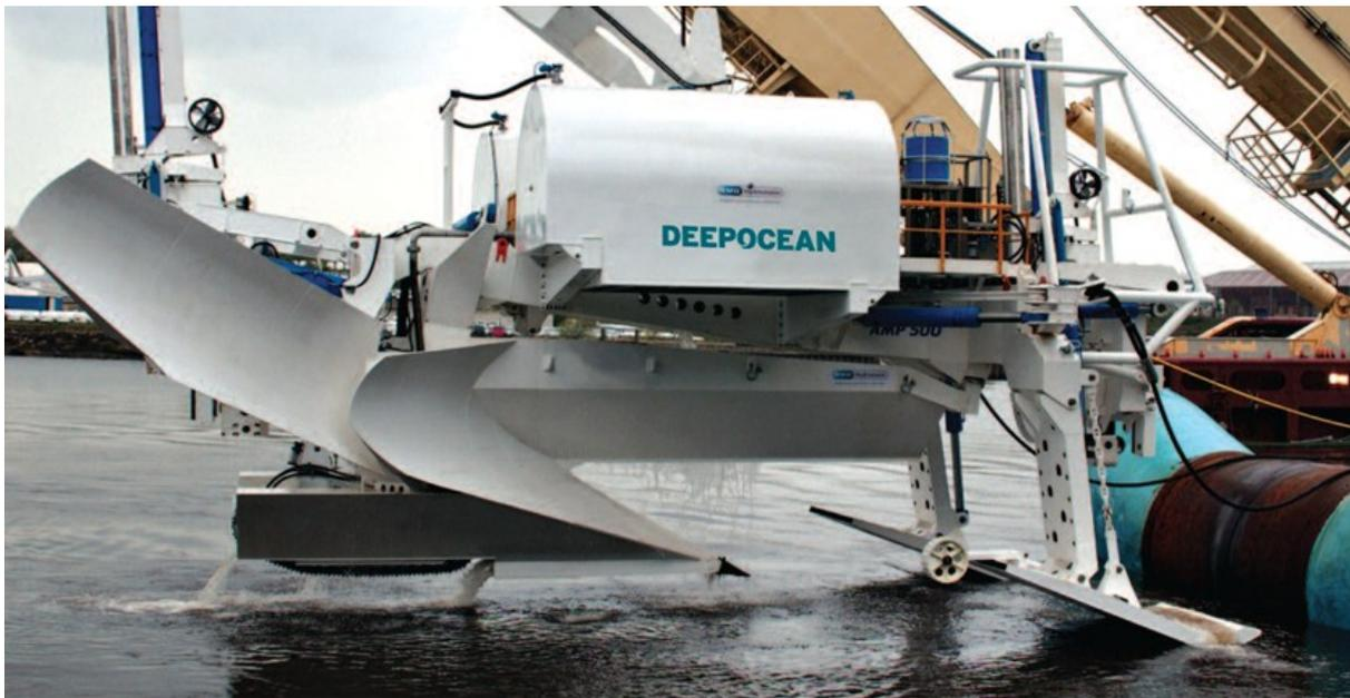
Abbildung 3.15 Fortschrittlicher AMP500-Mehrdurchgangspflug. Quelle: <https://www.subsea-rov.com/services-assets/trenchers-ploughs/item/74-amp500>
