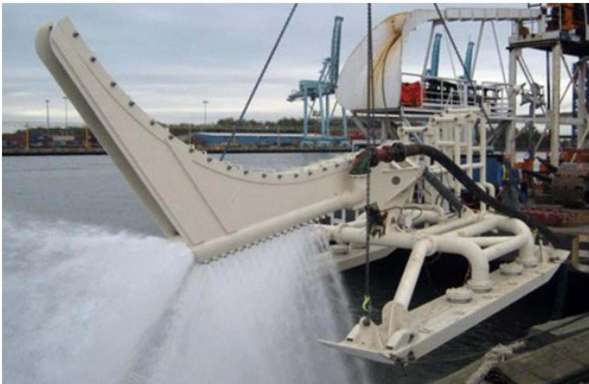
Abbildung 3.12 Mod-Jet/Sea Venture Stromkabelverlegungsschlitten (Quelle: <https://eta-ltd.com/jetting-sleds-for-subsea-power-cable-laying/>)
