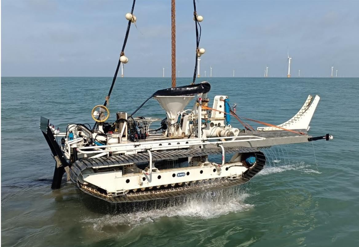
Abbildung 3.13 Bagger für Flachwassergraben (Shallow Water Trencher)(Quelle: <https://www.smd.co.uk/blog/may-2023-smds-shallow-water-trencher-the-story-so-far/>)
