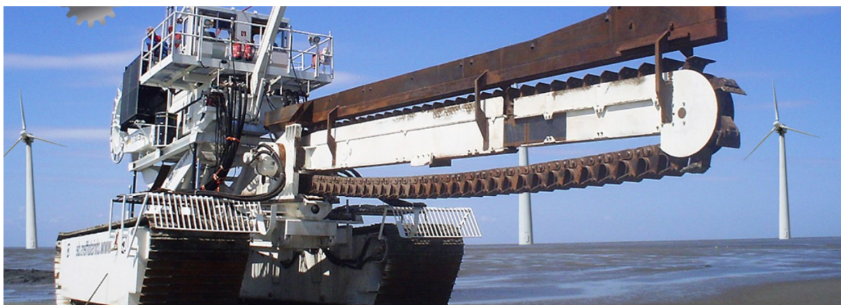
Rysunek 3.14 Urządzenie do zakopywania kabli w dnie morskim. Źródło: https://www.barthollandrain.nl/page/161
