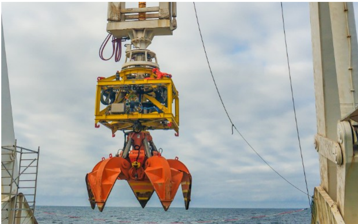
Rysunek 3.10 Assograpple II - wielofunkcyjne narzędzie przeznaczone do ingerencji w dno morskie (źródło: https://www.assogroup.com/equipment/seabed-preparation-equipment/pre-trenching-boulder-clearance/assograpple-ii/ )
