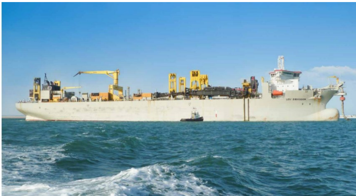
Rysunek 3.7 Przykładowa pogłębiarka wleczona ze zbiornikiem ssącym (źródło: https://www.jandenul.com/sites/default/files/2020-05/Leiv%20Eiriksson%20%28EN%29.pdf )
