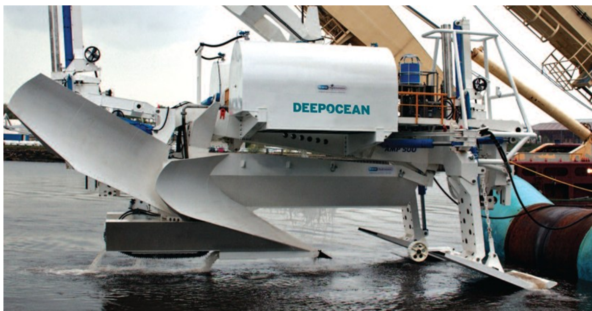
Rysunek 3.15 Zaawansowany pług wieloprzebiegowy AMP500. Źródło: https://www.subsea-rov.com/services-assets/trenchers-ploughs/item/74-amp500
