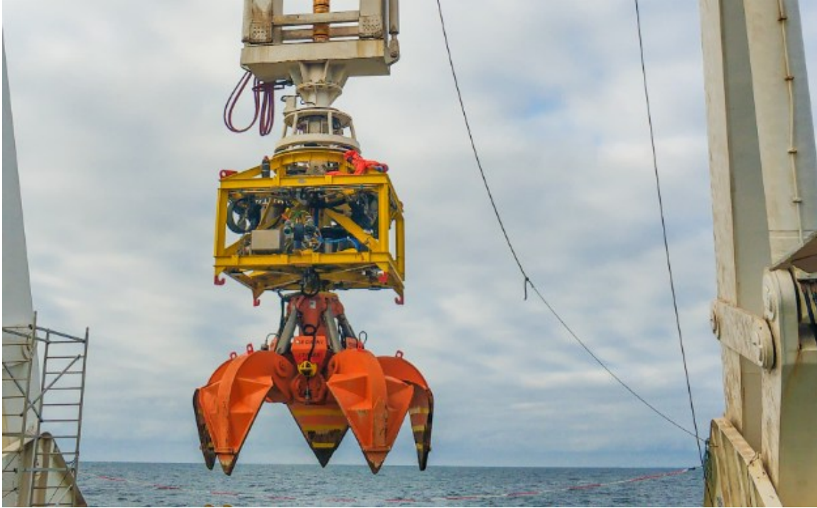
Figur 3.10. Assograpple II – multifunktionellt verktyg för ingrepp i havsbotten (källa:
