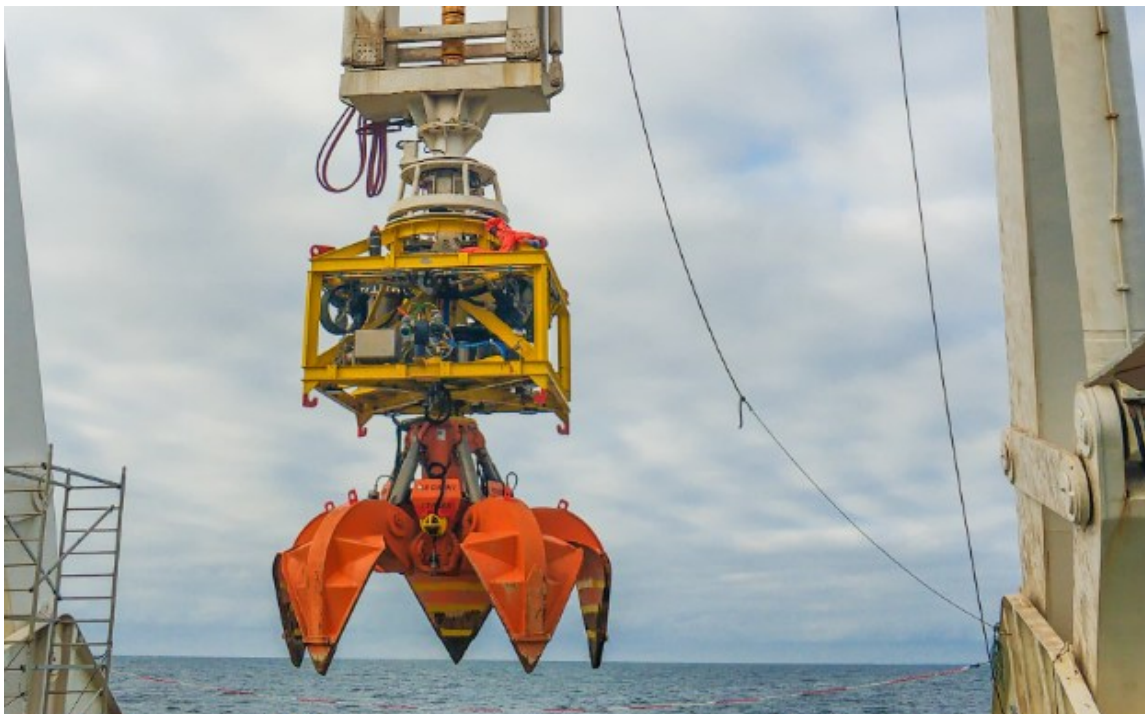
Rysunek 3.10 Assograppple II - wielofunkcyjne narzędzie przeznaczone do ingerencji w dno morskie (źródło: https://www.assogroup.com/equipment/seabed-preparation-equipment/pre-trenching-boulder-clearance/assograppple-ii/ )
