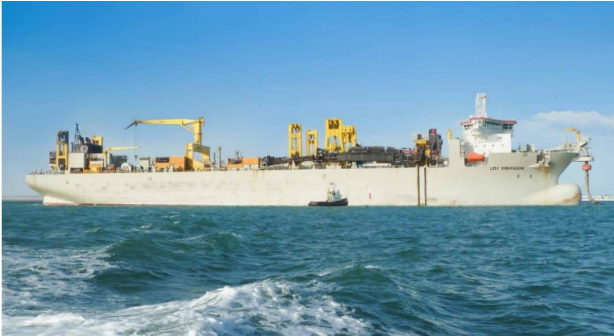
Rysunek 3.7 Przykładowa pogłębiarka włączona ze zbiornikiem ssącym (źródło: https://www.jandenul.com/sites/default/files/2020-05/Leiv%20Eiriksson%20%28EN%29.pdf )
