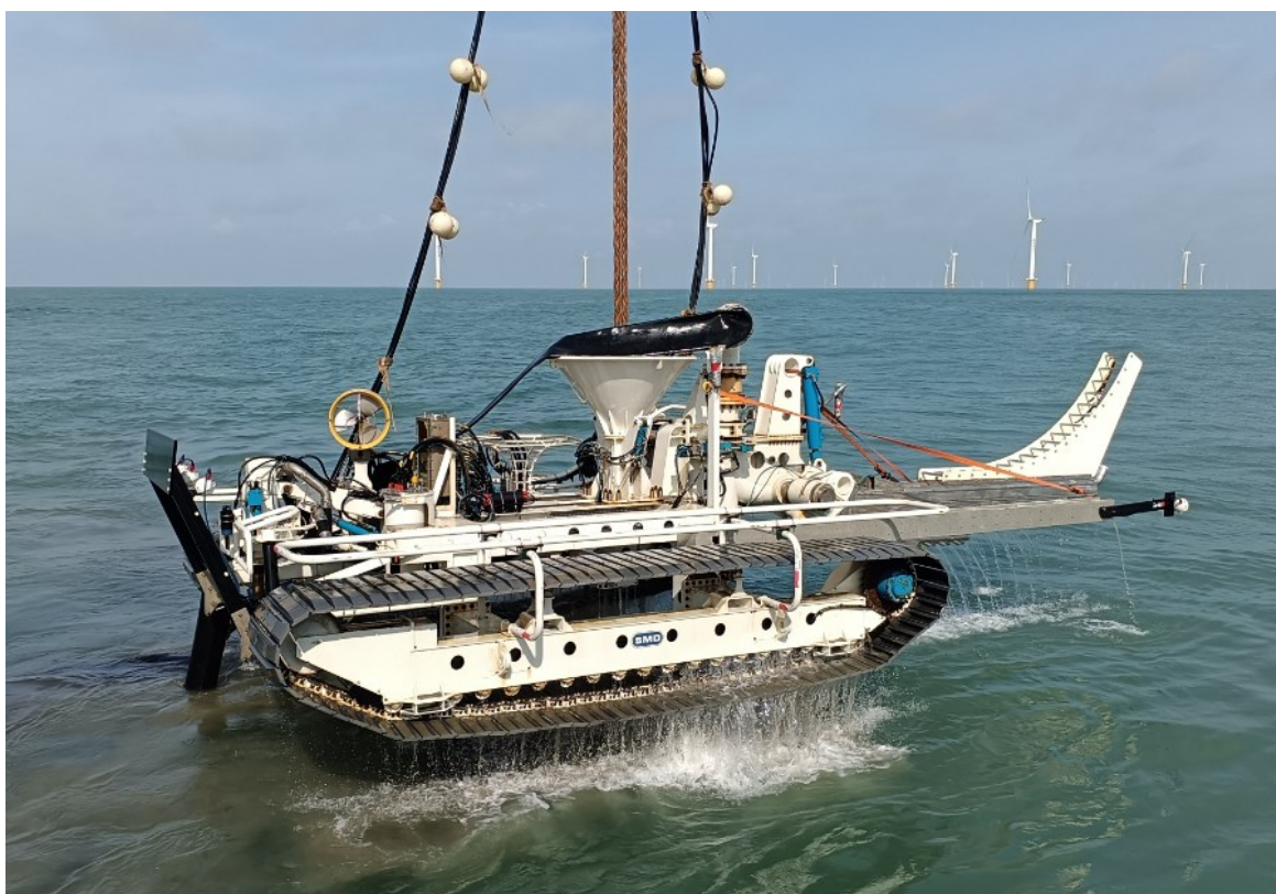
Rysunek 3.13 Koparka do rowów płytkiej wody (Shallow Water Trencher)(źródło: https://www.smd.co.uk/blog/may-2023-smds-shallow-water-trencher-the-story-so-far/ )
