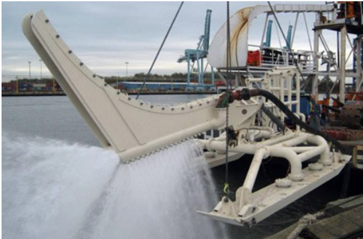
Figur 3.12. Släde för läggning av strömkablar Mod-Jet/Sea Venture (källa: https://eta-ltd.com/jetting-sleds-for-subsea-power-cable-laying/ )
