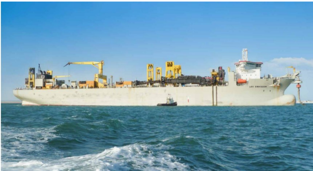
Figur 3.7. Exempel på mudderverk med sugbehållare (källa: https://www.jandenul.com/sites/default/files/2020-05/Leiv%20Eiriksson%20%28EN%29.pdf )
