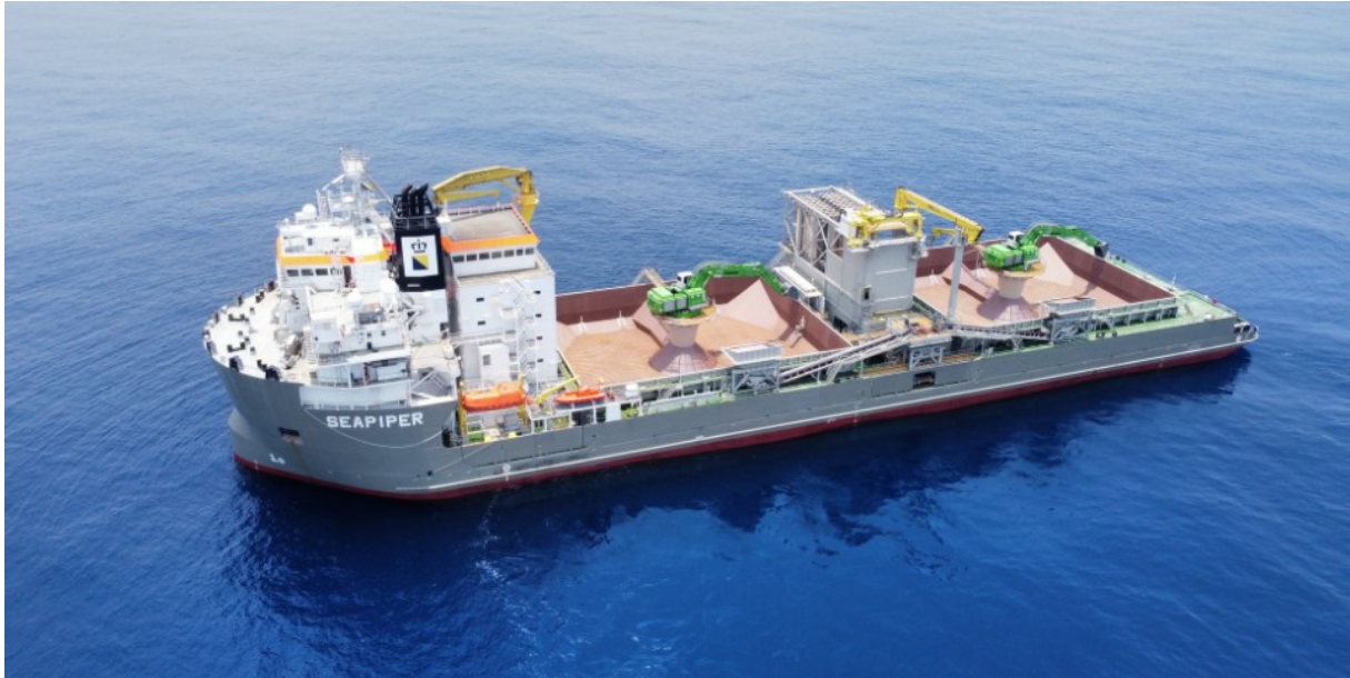
Figur 3.8. Exempel på fallrörsfartyg (källa: https://www.portalmorski.pl/zegluga/53382-nowy-podsykowiec-boskalisa )
