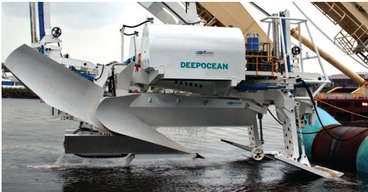
Abbildung 3.15 Fortschrittlicher AMP500-Mehrdurchgangspflug. Quelle: https://www.subsea-rov.com/services-assets/trenchers-ploughs/item/74-amp500
