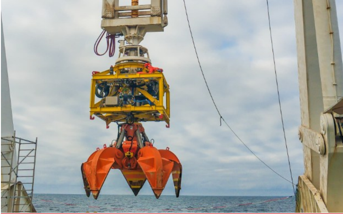
Figur 3.10. Assograpple II – multifunktionellt verktyg för ingrepp i havsbotten (källa:
