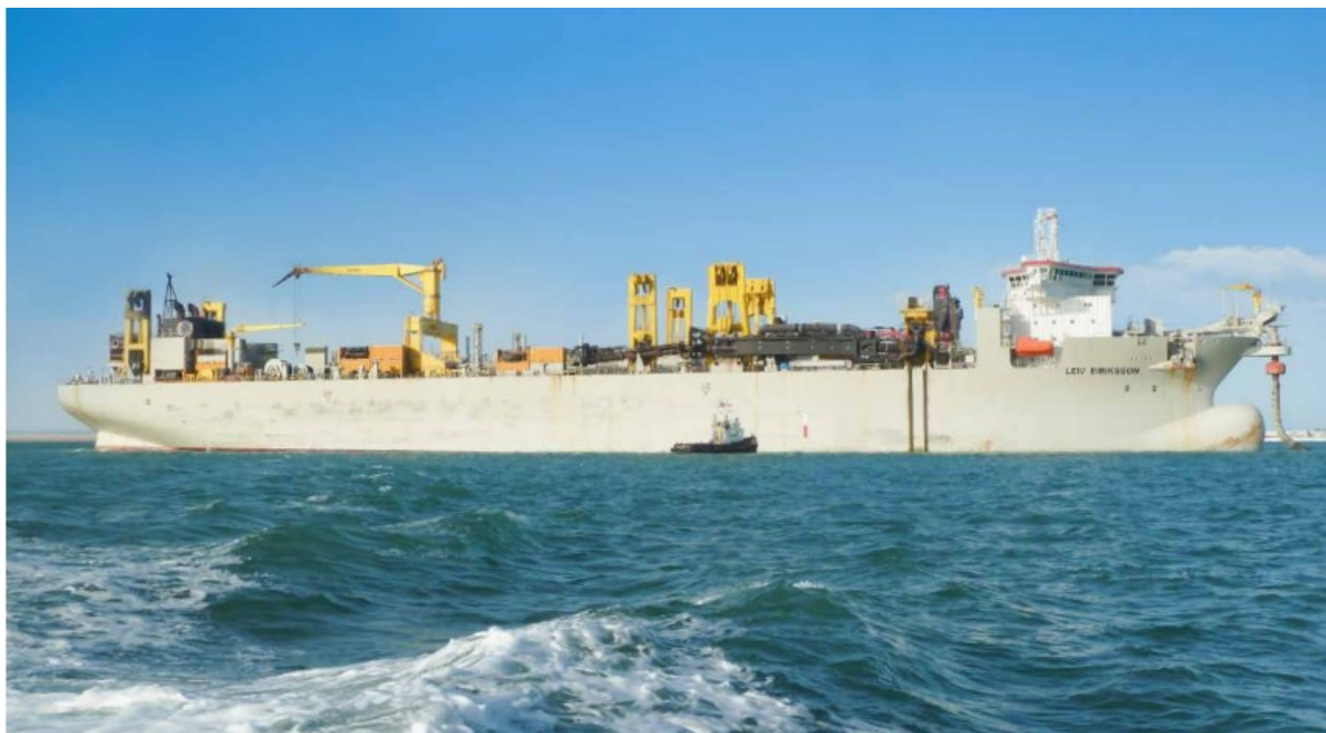
Figur 3.7. Exempel på mudderverk med sugbehållare (källa: https://www.jandenul.com/sites/default/files/2020-05/Leiv%20Eiriksson%20%28EN%29.pdf )
