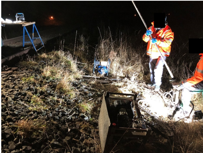
Abbildung 6: KRB 4 und DPL 4 im Böschungsbereich
